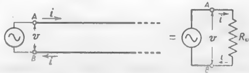
Fig. 7 — Per ciò che riguarda il generatore la linea indefinitamente lunga equivale ad una resistenza R_0 .
