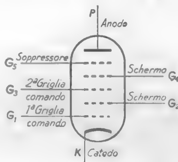
Fig. 6 — Disposizione degli elettrodi del tubo pentagriglia.
