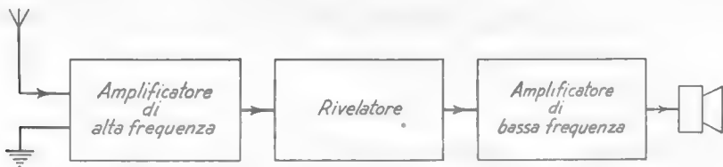
Fig. 1 — Schema di principio di un radoricevitore.
